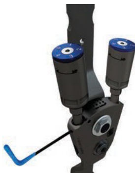
Kuva 1. Vapauta / lukitse ROM-säätö käyttäen 1,5 mm:n Kuusiokoloavainta ROM-lukituksen asetusruuvien höllentämiseksi/kiristämiseksi.
