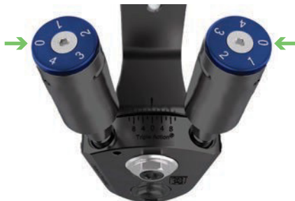
Kuva 3. Löysytä ROM-säätöruuvia käyttäen 2 mm:n säätöavainta ja nollaa ROM-asetus kääntämällä sinistä ROM-säädintä. ROM-lukituksen säätöruuvia tarvitaan viitteenä tässä säädössä (kuvat 3a ja 3b).
